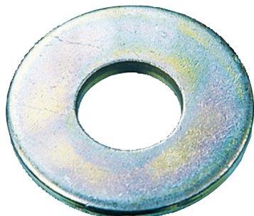
Aluslevy, SFS3738/ISO4759, sähkösinkitty
