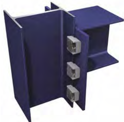
Rei'itetyllä päätelevyllä varustetun vaakapalkin liittäminen pystypalkkiin
